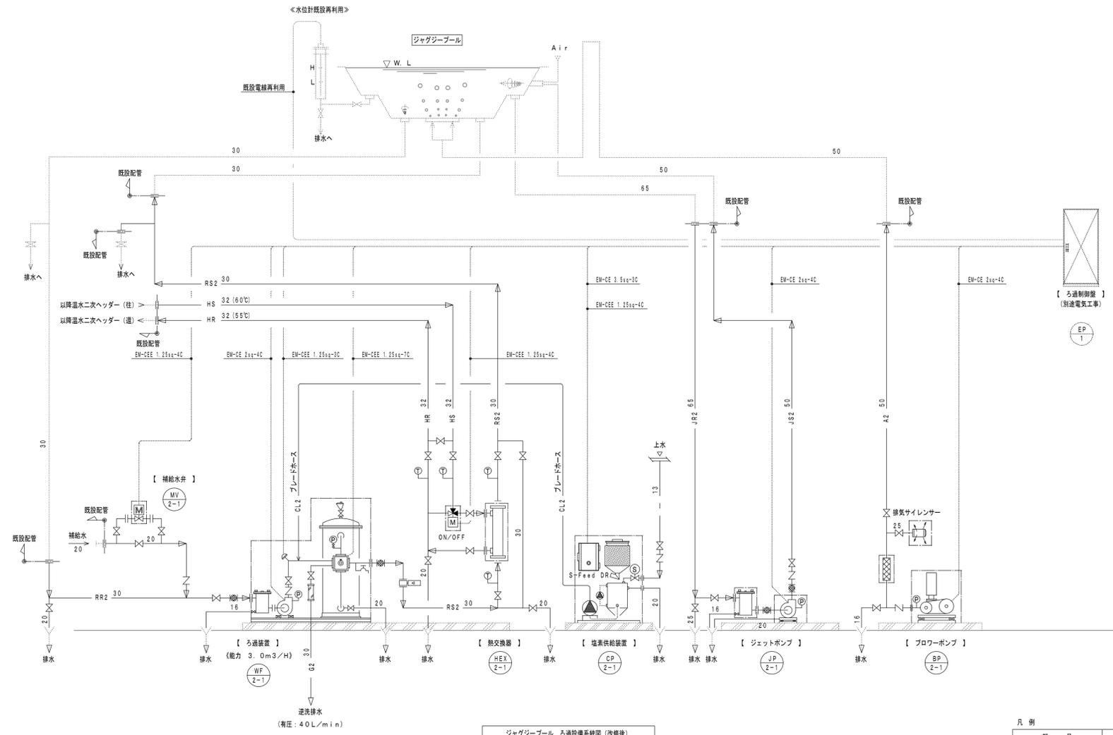
ジャグジープールろ過機系統図(改修後)
